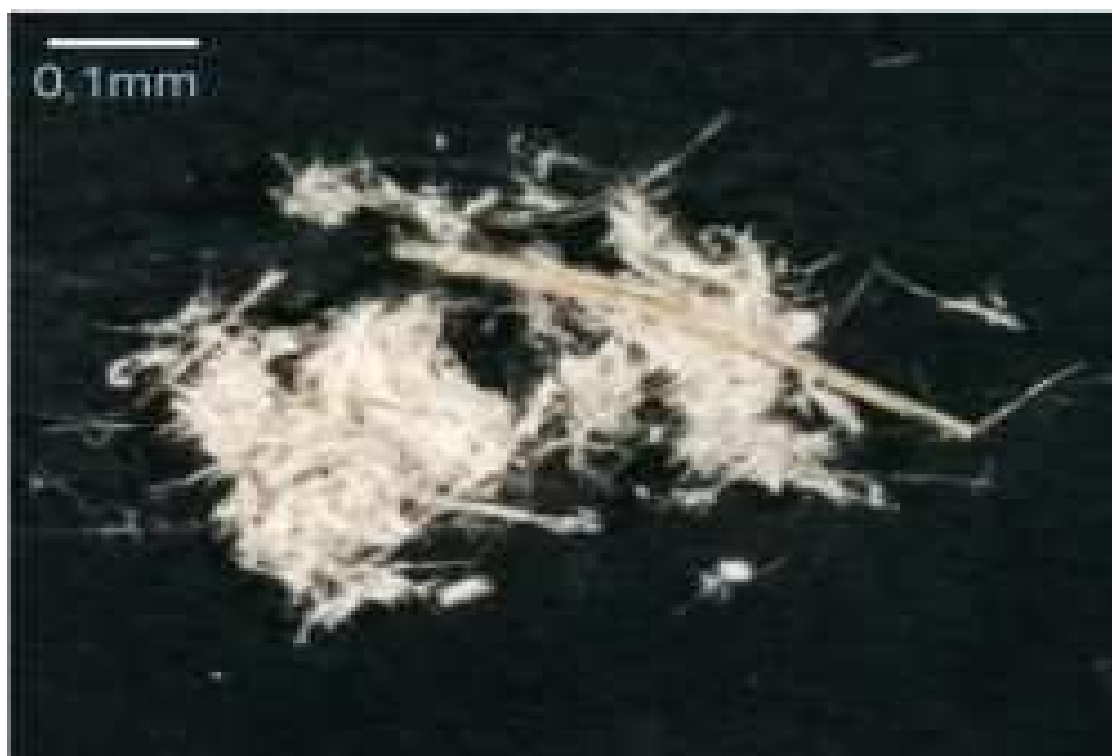
Zdjęcie Nr 1. Azbest chryzotylowy tzw. twardy, krótkowłóknisty, zawiera CaCO 3
